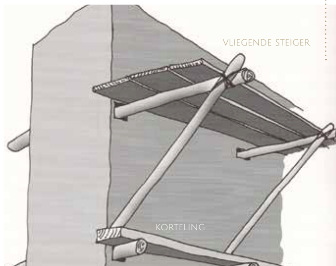
> AFB. 6 – HET PRINCIPE VAN DE VLIEGENDE STEIGER. TEKENING DIK DE ROON.
